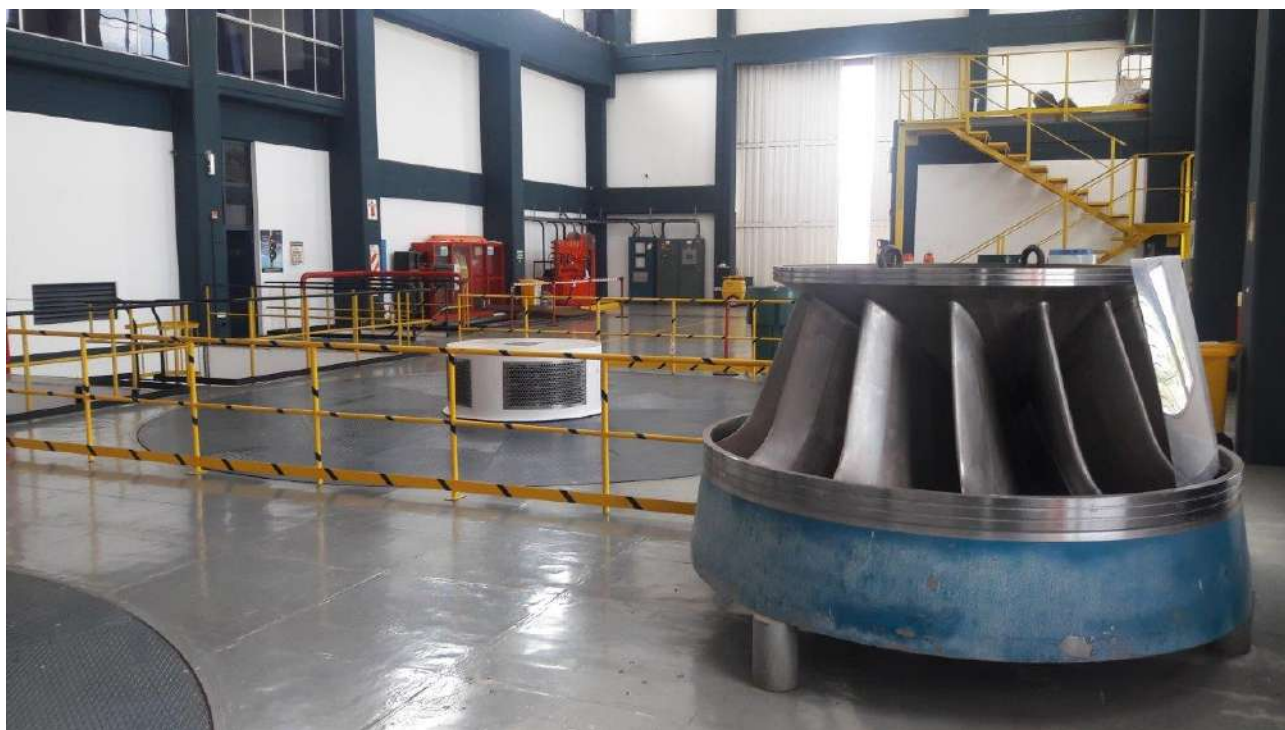
Sala de máquinas y Rodete turbina Francis Central El Tunal
