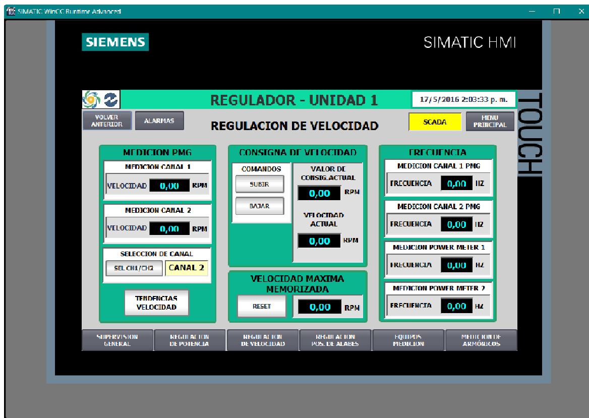
Fig. 2-1: Pantalla HMI para lectura y control de la velocidad de la turbina
